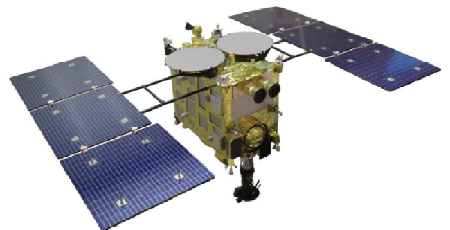
※「はやぶさ2」 JAXAの小惑星探査機。重量 600kg、大きさは 1.0m x 1.6m x 1.4m。2020年末小惑星「リュウグウ」からサンプルを採取して地球帰還予定
